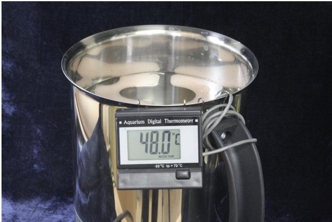
Abb. 12, Erkodent Wasserbad mit digitalem Thermometer
